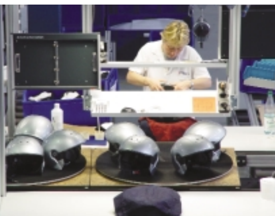
△ Die Endmontage der Helme erfolgt sowohl über Montagebänder, als auch über spezielle Montagewagen-Systeme. Die komplette Helm-Innenausstattung wird hier manuell eingebaut und überprüft.
